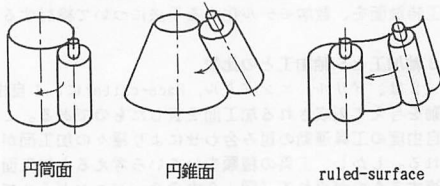
図-3. 直線切刃による加工特徴面
