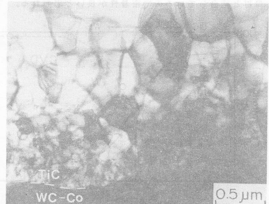
Fig. 4 CVD/TiC膜の微細組織
