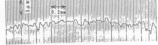
図5 各傾斜角におけるアルミナ試料の断面曲線
