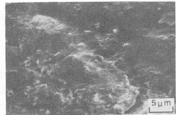
図7 常温固相接合後の銅の表面(2)
