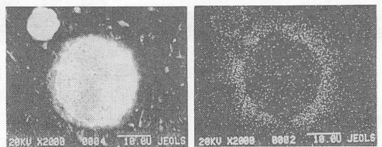
図2 複合粉末断面のSEM、特性X線像
