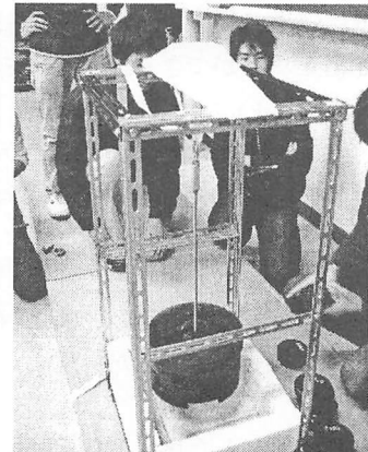
図 2 ブリッジの耐荷重試験
