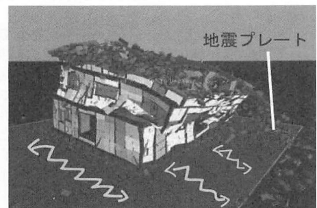
図3 倒壊プロセスシミュレーション
