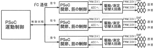
図5 分散モジュール型拮抗筋制御構造の概要
