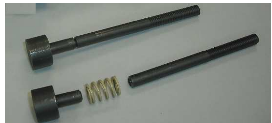
図7 破断した第2部材
