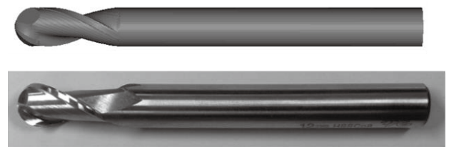
Fig.6 生成したモデル(上)と実際の工具(下)
