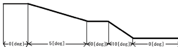
図5 斜路の傾きを模した断面
