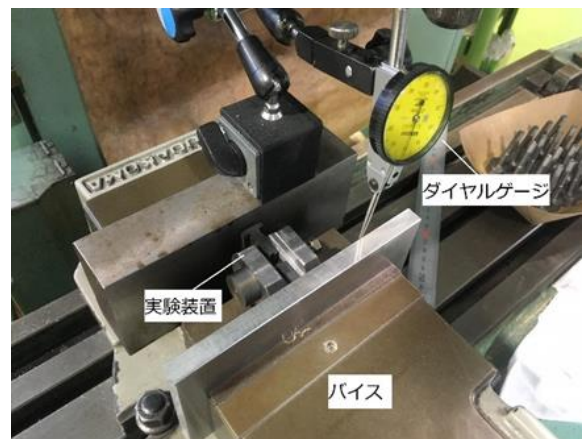
図6 せん断破壊検知実験状況
