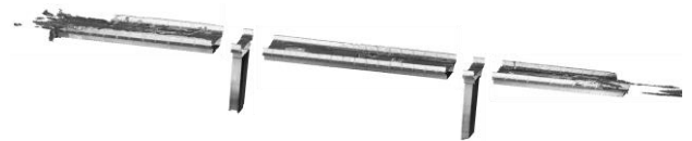
図 6 分割した橋梁 SfM3D モデル
